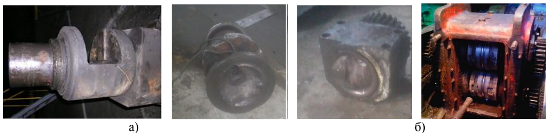
Рис. 1. Разрушенные узлы рабочей клетки стана ХПТ 32: а – валок под калибр в виде полудиска; б – станина клетки
